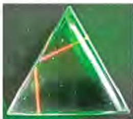
चित्र 10.23 समबाहु त्रिभुजीय प्रिज्ममा हुने पूर्ण आन्तरिक परावर्तन
