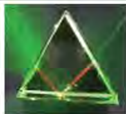
चित्र 10.24 समकोण त्रिभुजीय प्रिज्ममा हुने पूर्ण आन्तरिक परावर्तन
