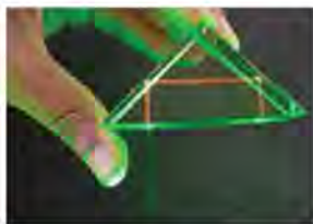
चित्र 10.24 समकोण त्रिभुजीय प्रिज्ममा हुने पूर्ण आन्तरिक परावर्तन
