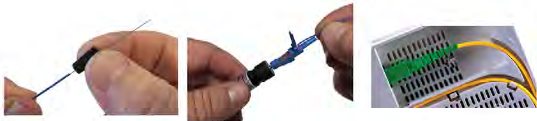
चित्र 10.32 राउटरमा अप्टिकल फाइबर कनेक्टरको जडान
