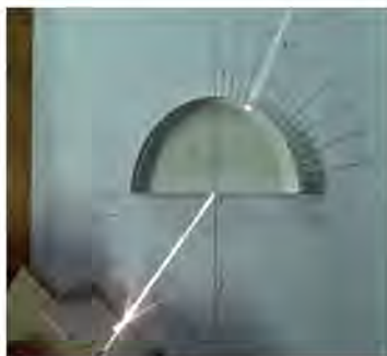
चित्र 10.10 अर्धवृत्ताकार काँचको स्ल्याबबाट प्रकाशको आवर्तन
